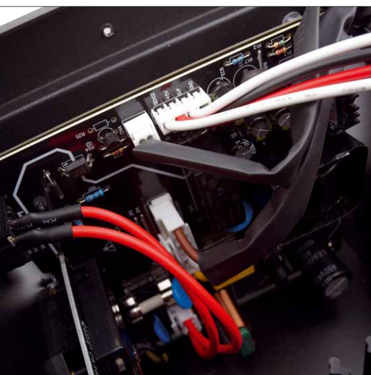
Und auch die Phonoplatine ist fernab des Geschehens in einem eigenen Bereich untergebracht
